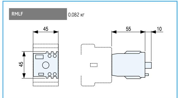
Механическая /электромеханическая блокировка
