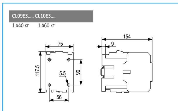
Чертежи и размеры. Четырехполюсные контакторы
