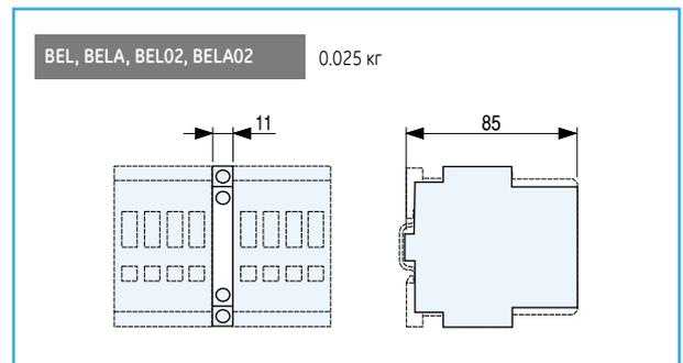
**Блок электронного таймера**
